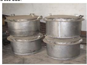
Description: Chaque conduit sera constitué avec une feuille de tôle INOX 200x100x1,5 mm. La feuille sera cintrée pour souder sur une ligne pour obtenir un cylindre parfait. Un embout male (surtôle) sera rajouté pour permettre l'emboitement des conduits entre eux et avec la base. Le conduit disposera de 2 pattes de scellement (fait de chute de tôle) d'environ 40 cm de long sur 2 à 3 cm de large.
