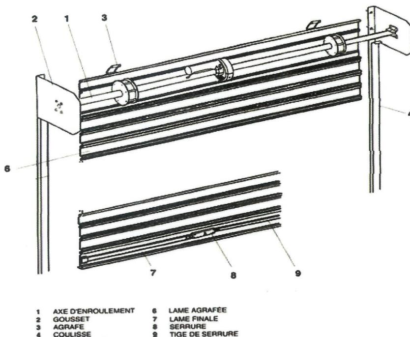
Les rideaux sont à lames pleines en acier galvanisé, totalement fermés pour offrir un bon niveau de sécurité. Les rideaux doivent être motorisés au moyen d'un moteur tubulaire monophasé équipé d'un dispositif de dépannage. Les moteurs tubulaires permettent d'enrouler ou de déployer le rideau métallique, même sans électricité.
